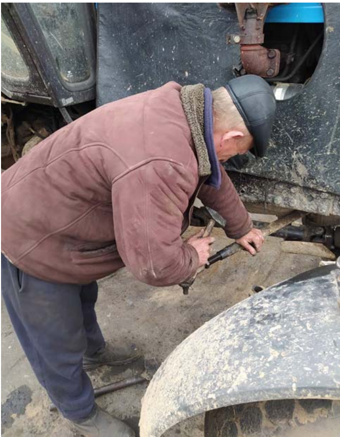
Работник при работе с инструментом ударного действия не применяет очки защитные и находится в личной одежде и обуви
