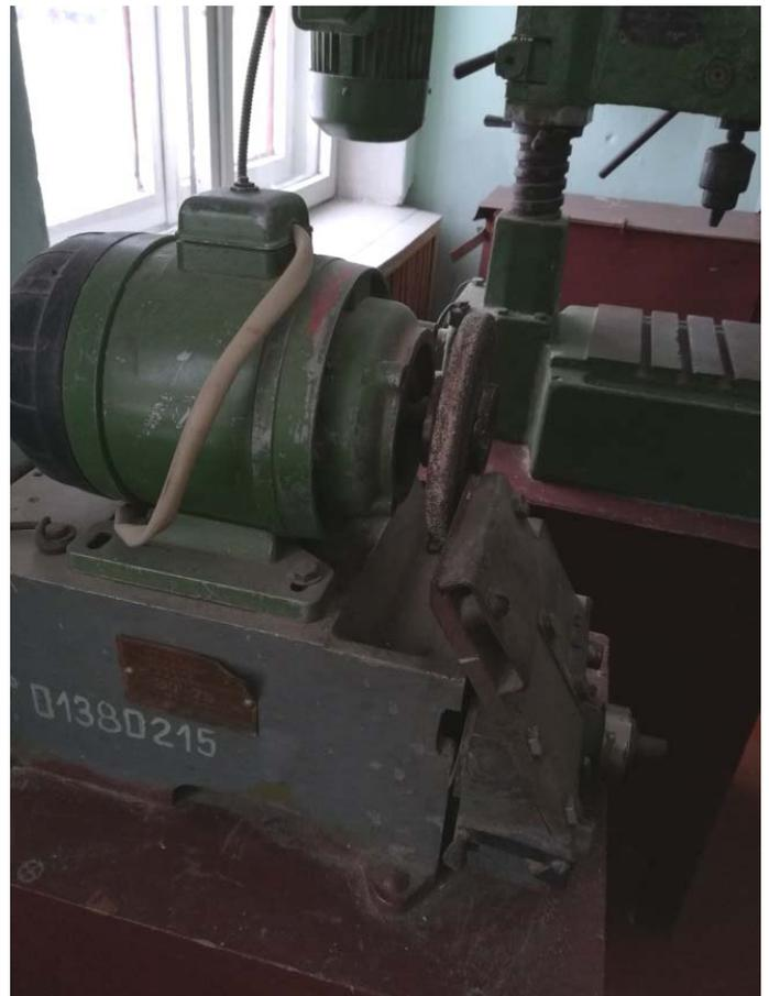
**На станке отсутствуют защитный кожух, защитный экран, заблокированный с пусковым устройством электродвигателя, подручник; станок не оснащён кнопкой «Стоп» красного цвета с грибовидным толкателем для экстренной остановки станка и др.**
