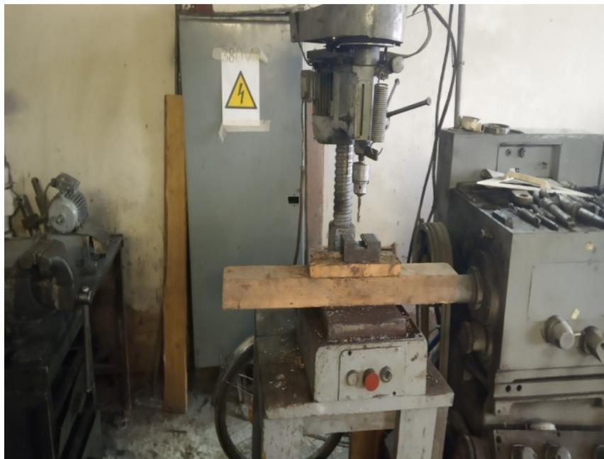
**На станках отсутствуют стационарные или ручные зажимные приспособления, отсутствует местное освещение**
