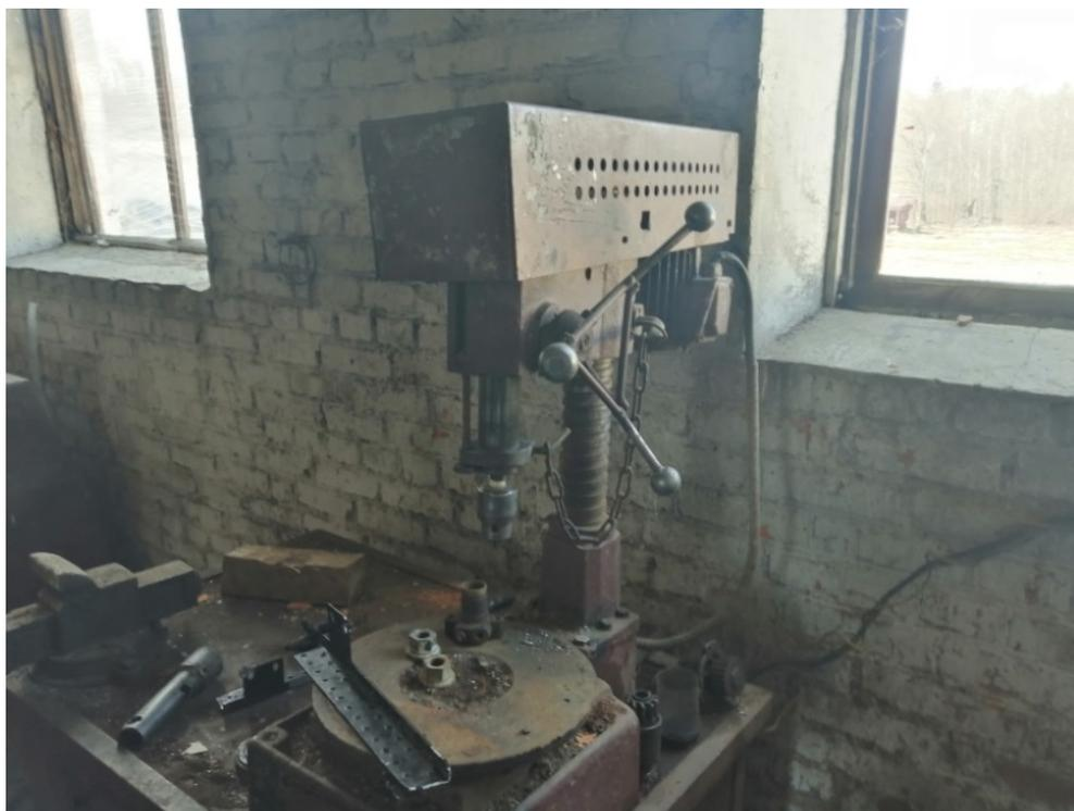
**На станке отсутствуют стационарные или ручные зажимные приспособления; неисправно устройство, предотвращающее самопроизвольное опускание шпинделя станка; отсутствует местное освещение**
