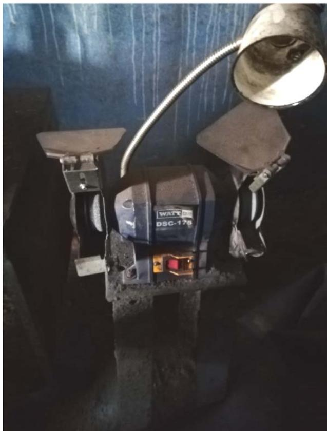
**Предельный износ абразивного круга; станок не оснащён кнопкой «Стоп» красного цвета с грибовидным толкателем для экстренной остановки, отсутствует подручник, неисправно местное освещение и др.**
