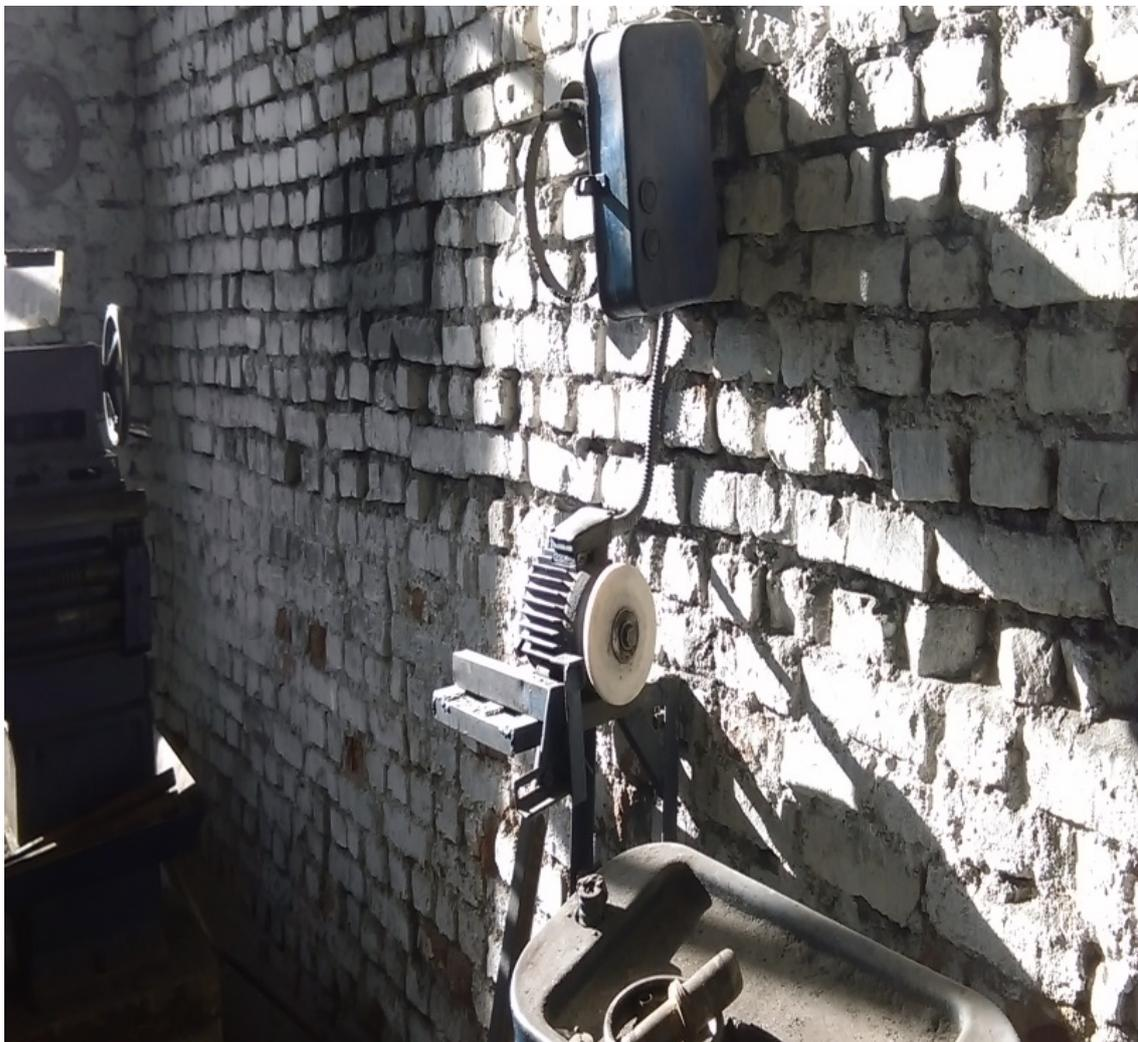
**К эксплуатации допущены самодельные заточные станки,
