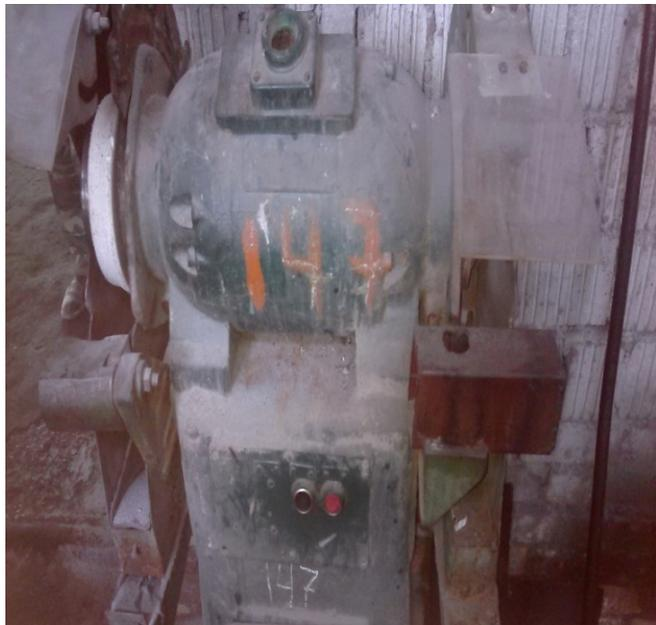
**На шлифовально-обдирочном станке не указано хорошо видимой стрелкой направление вращения шпинделя, откидывающийся защитный экран не заблокирован с пусковым устройством электродвигателя, не работает пылеотсасывающее устройство, станок не оснащён кнопкой «Стоп» красного цвета с грибовидным толкателем для экстренной остановки и др.**
