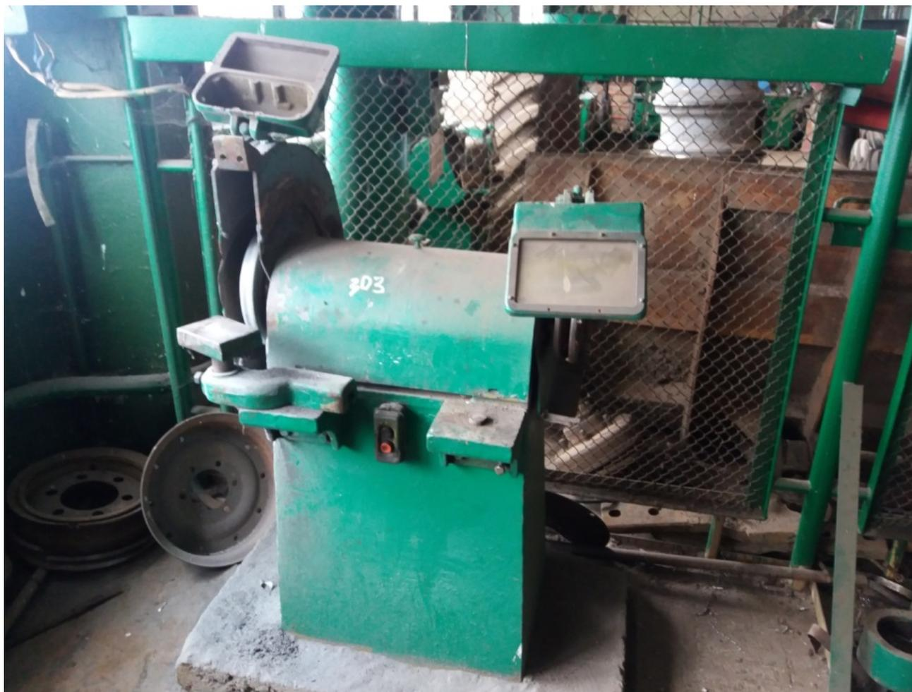
**На рабочем месте около станка отсутствуют деревянные трапы; легкосъёмные защитные ограждения (откидывающийся защитный экран) не заблокированы с пусковым устройством электродвигателя; части станка, представляющие опасность, и внутренние поверхности ограждений, открывающиеся без применения инструмента, не окрашены в сигнальные цвета и не обозначены знаком безопасности и др.**
