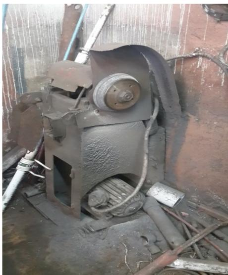
**На заточном станке отсутствуют защитное ограждение абразивного круга, подручник, защитный экран, круг изношен, пылеотсасывающее устройство не работает**
