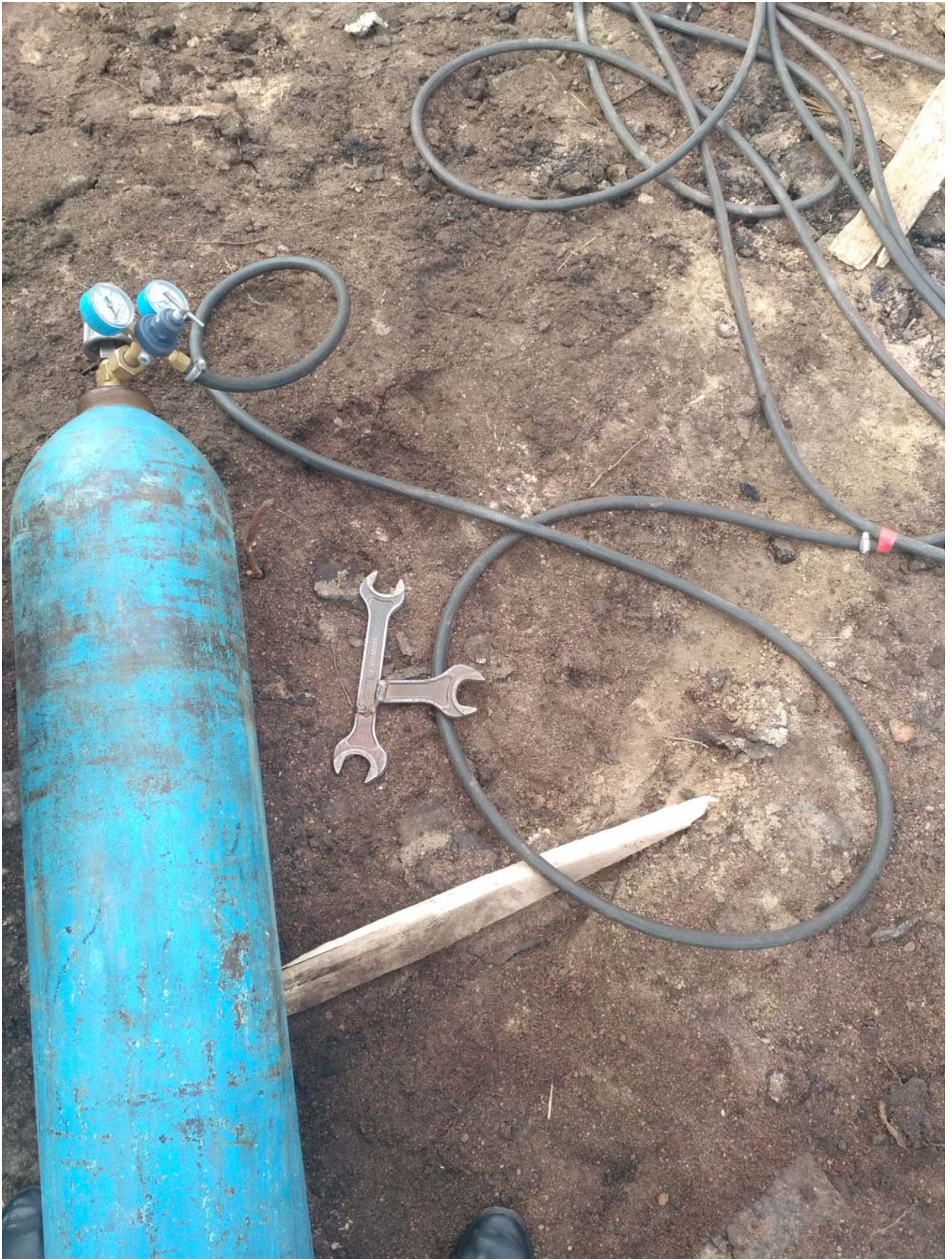
Гаечные ключи соединены между собой при помощи сварки
