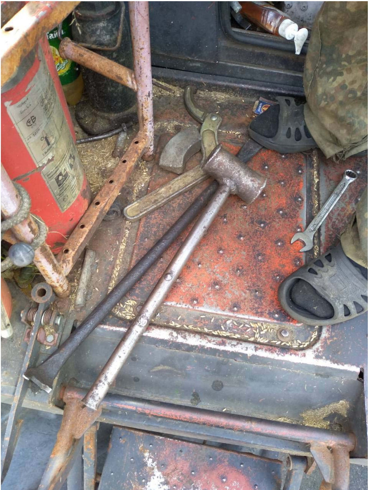
Рукоятка кувалды выполнена из металлической трубы. Работник находится на рабочем месте в личной обуви.
