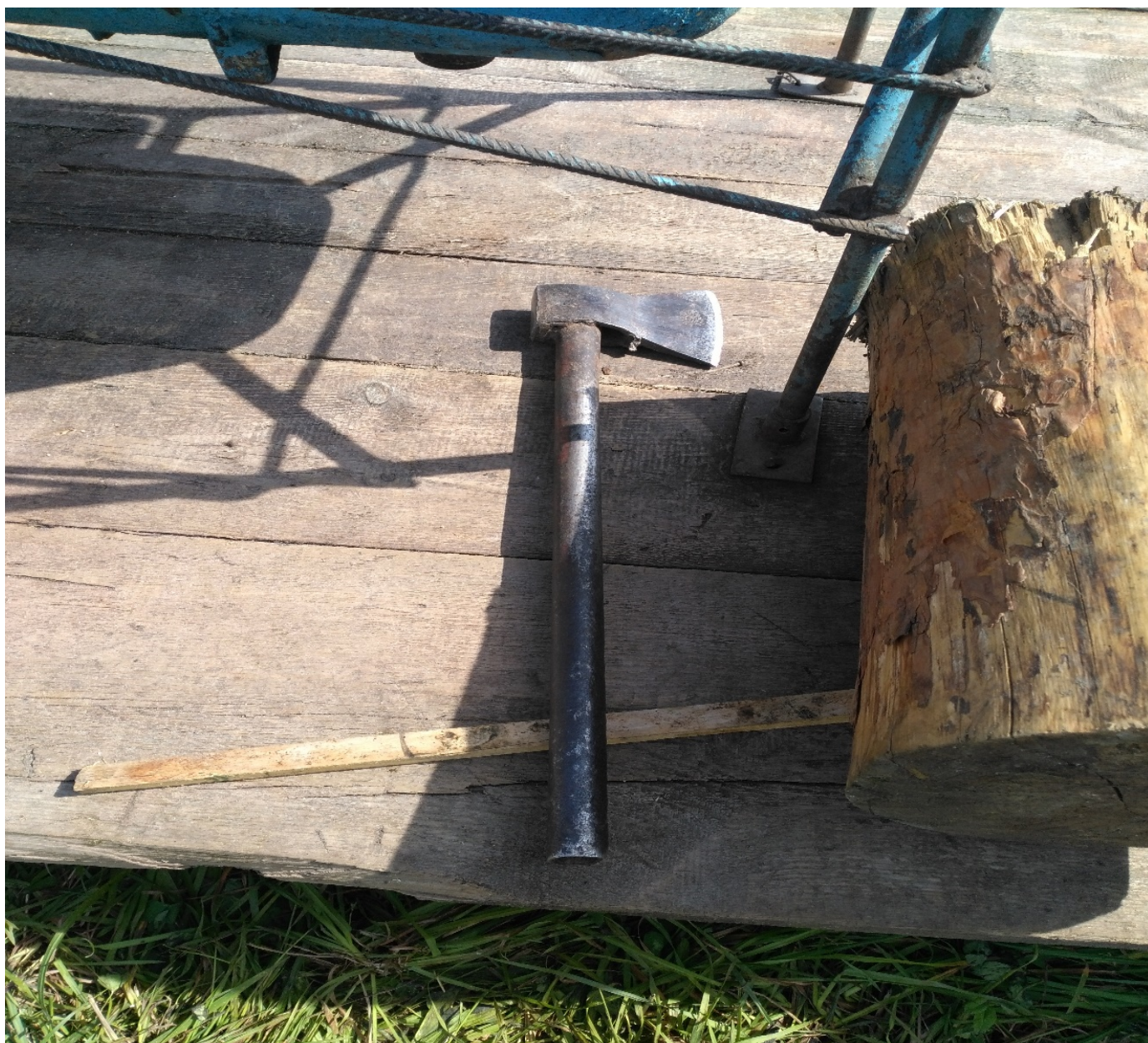
Топорище выполнено из металлической трубы
