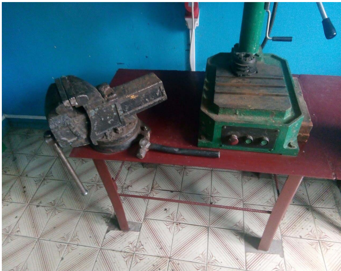
Рукоятка молотка выполнена из металлической трубы. На бойке молотка имеются заусенцы и наклёп
