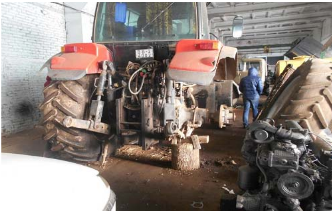
находящийся на ремонте трактор установлен на случайные предметы (деревянные колодки и доски), беспорядочное складирование запасных частей, деталей
