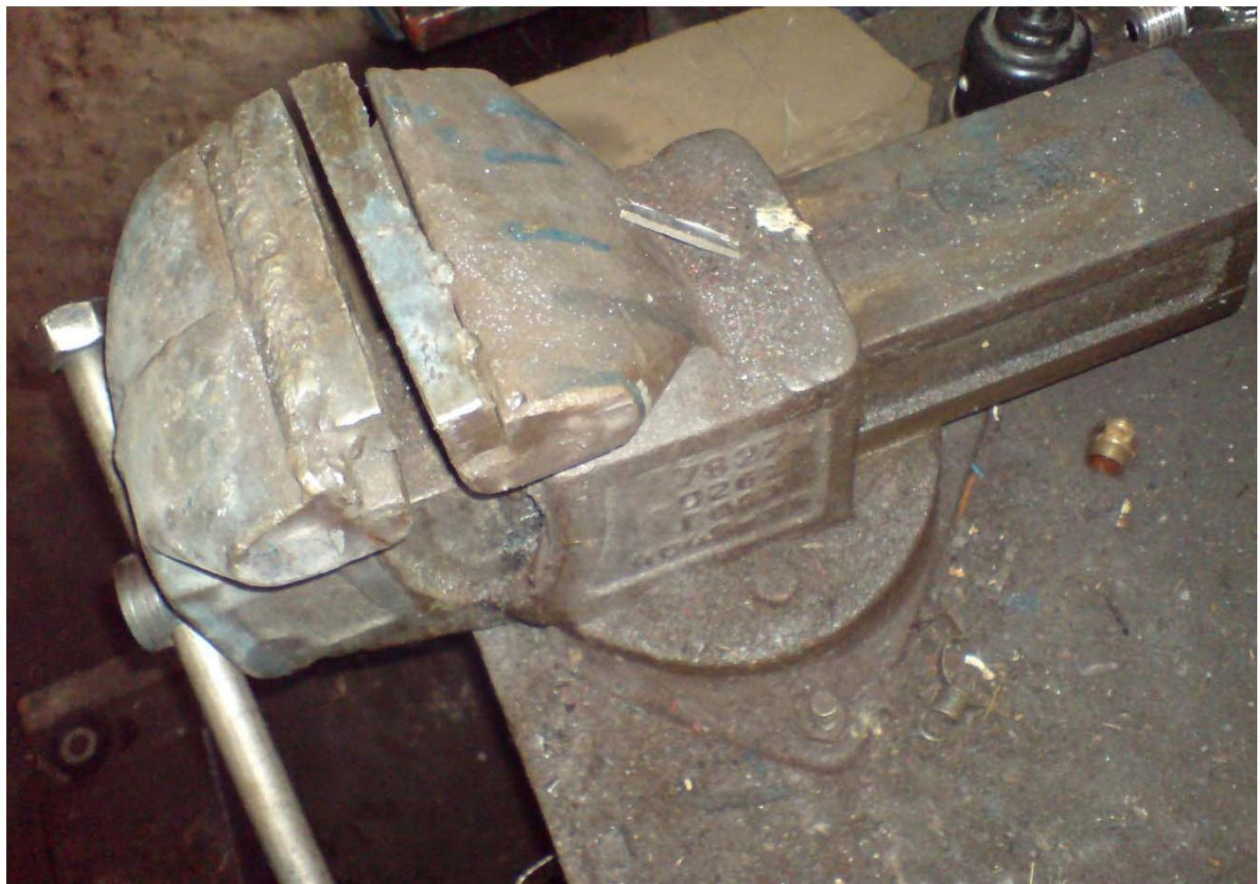
Губки тисков не обеспечивают прочный захват зажимаемого изделия
