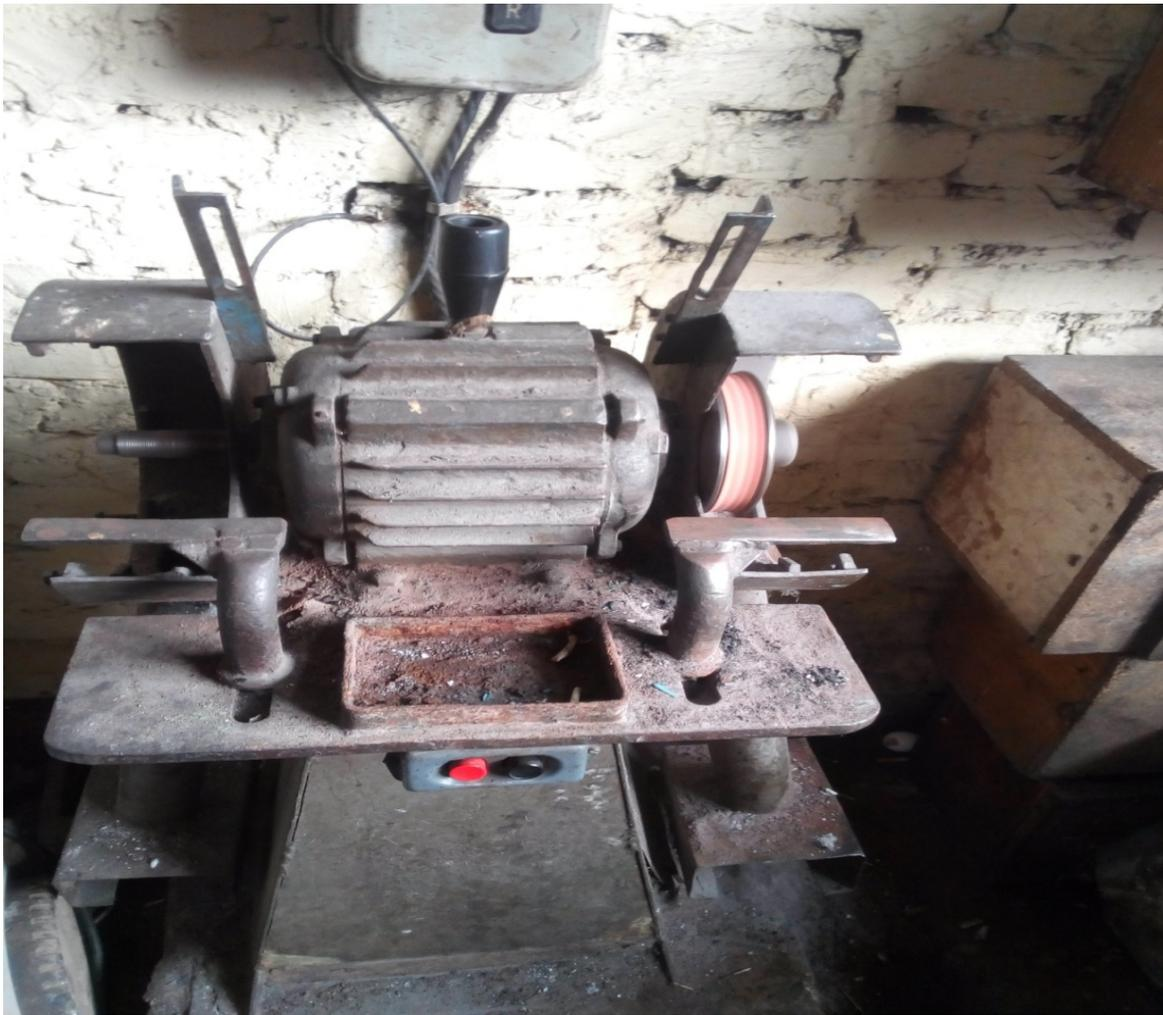
**Эксплуатация данного обдирочно-шлифовального станка осуществляется без защитных экранов, с абразивным кругом, без балансировки и защитных кожухов. Пуск станка не заблокирован с предохранительным экраном, подручники не отрегулированы и имеют зазор более 3 мм. Станок не оснащен кнопками «Стоп» красного цвета с грибовидным толкателем, для его экстренной остановки**
