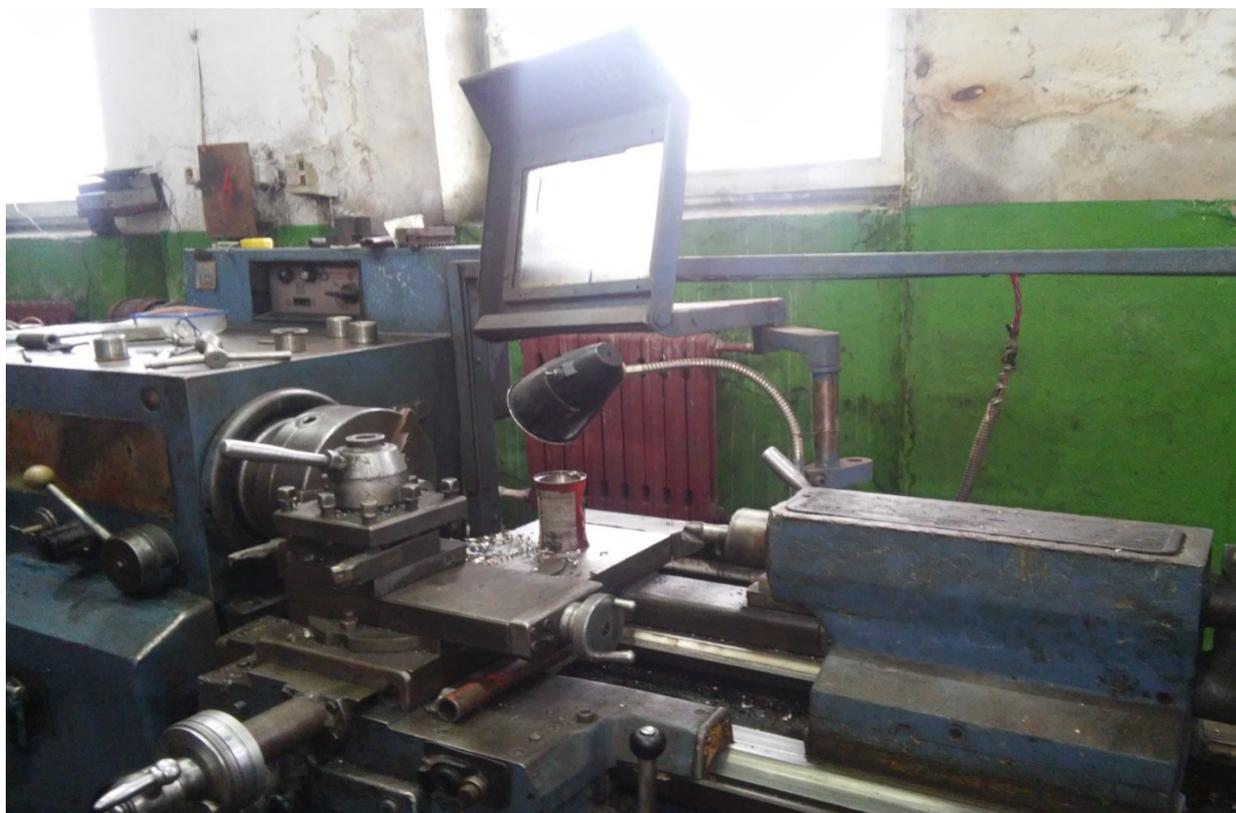
**Данный токарный станок не оснащён кнопкой «Стоп» красного цвета с грибовидным толкателем, находящимся в легкодоступных местах, для экстренной остановки**
