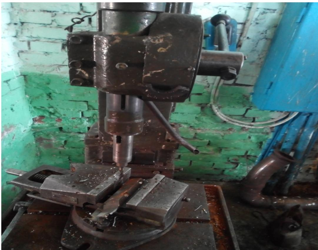
**Сверлильный станок не оборудован устройством, предупреждающим самопроизвольное опускание шпинделя**
