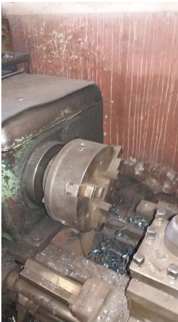
**Токарно-винторезный станок 1К62 не оборудован легко отводимым защитным ограждением зажимного патрона, имеющим блокировку, которая автоматически отключала бы станок при открывании ограждения**
