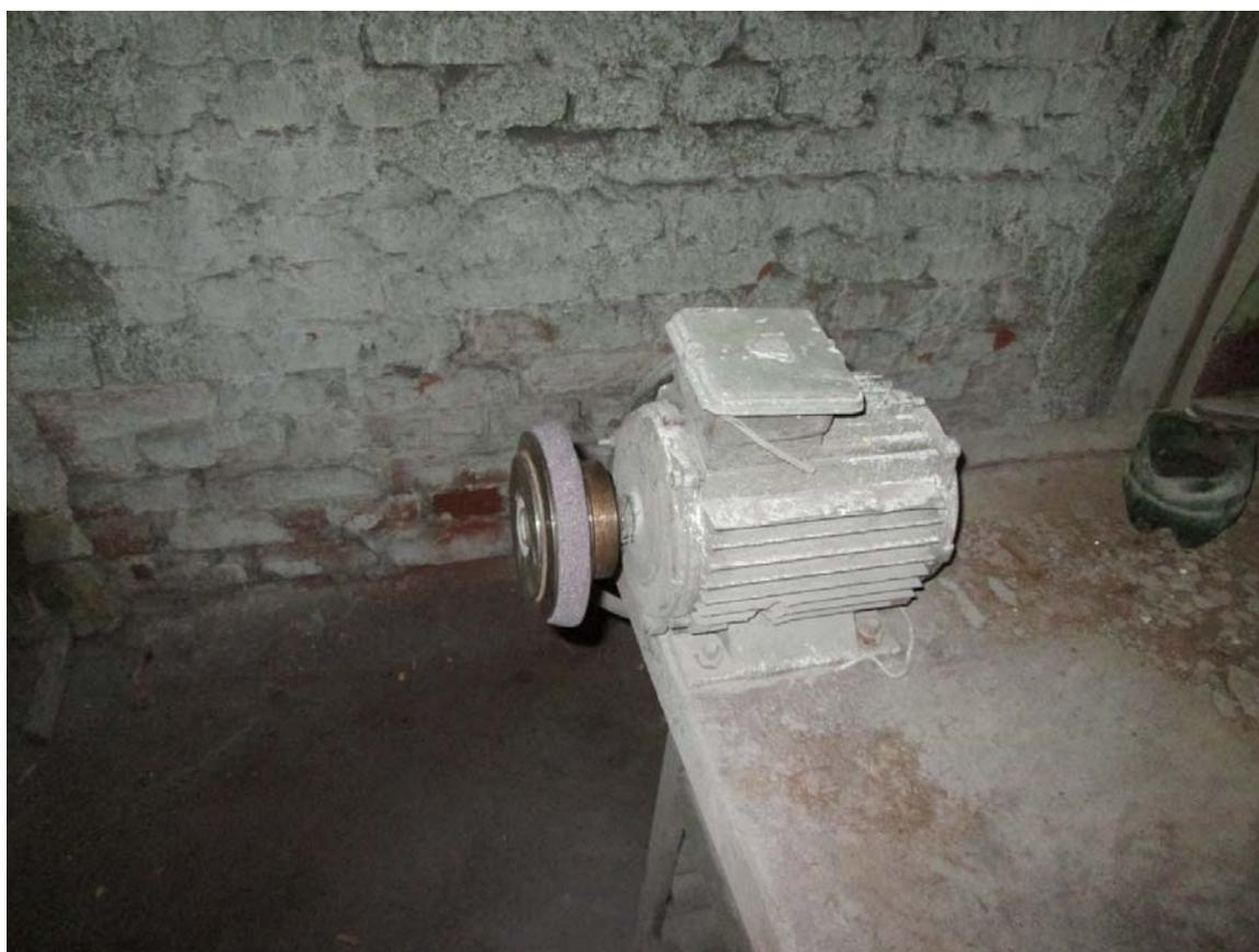
На данном заточном станке отсутствуют подручник и защитный экран, не указано направление движения шпинделя абразивного круга хорошо видимой стрелкой и др.
