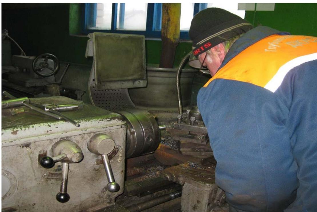
**Токарный станок не оборудован легко отводимым защитным ограждением зажимного патрона, имеющим блокировку, которая автоматически отключала бы станок при открывании ограждения**
