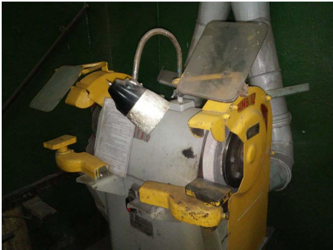
Защитные ограждения этого заточного станка не заблокированы с приводом для отключения при их открывании или снятии, для экстренной остановки станок не оснащен кнопками «Стоп» красного цвета с грибовидным толкателем, находящейся в легкодоступном месте
