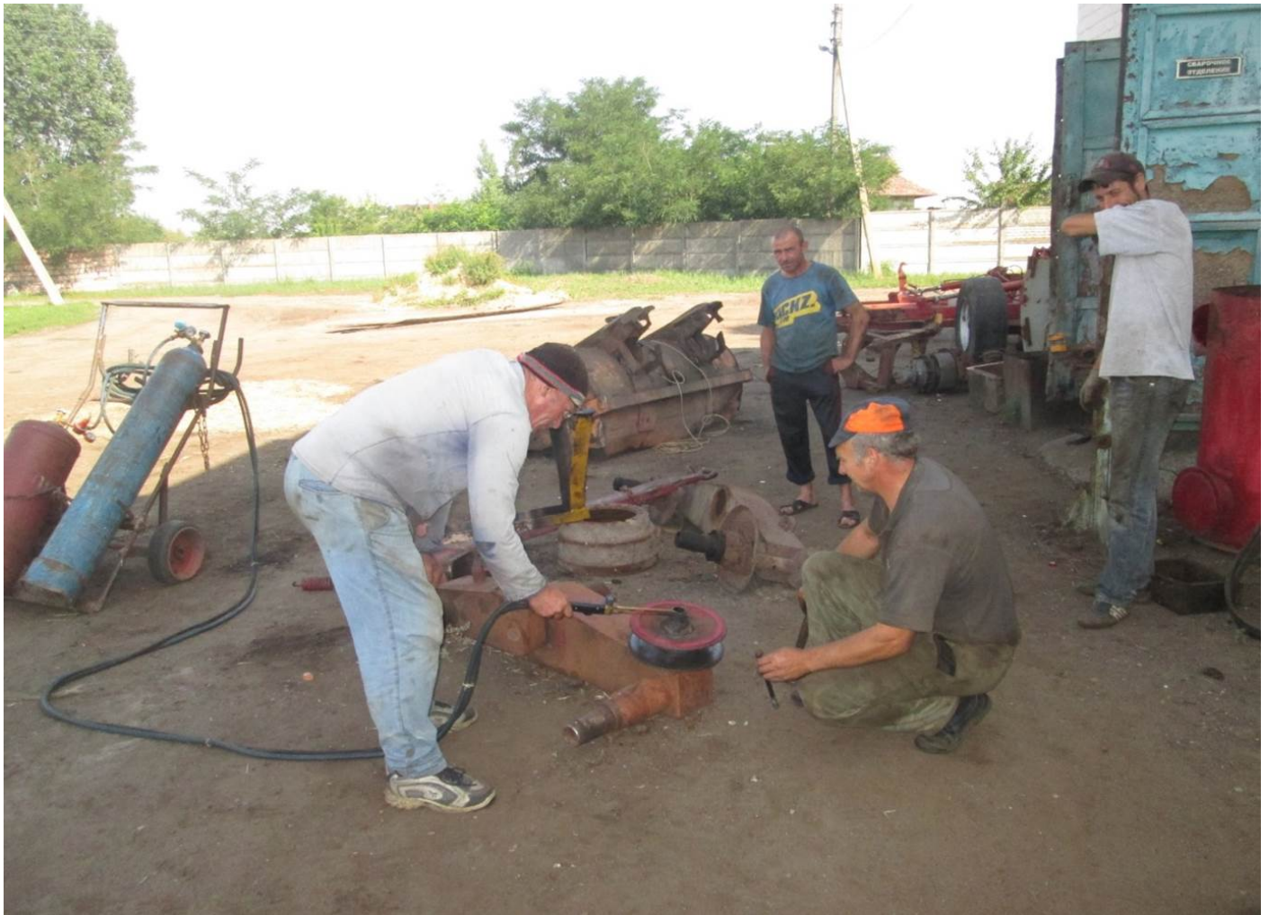
Выполнение работниками огневых работ без применения средств индивидуальной защиты
